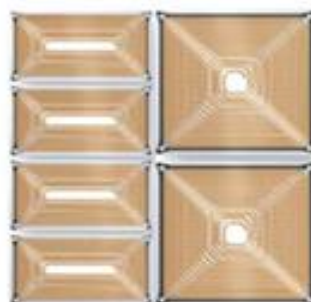
Links: vlakkendekkende spoelen. Rechts: vierkante spoelen.
